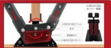
※ダンパーの回転による高減衰ゴムのせん断変形を赤色で示したイメージ図です。
